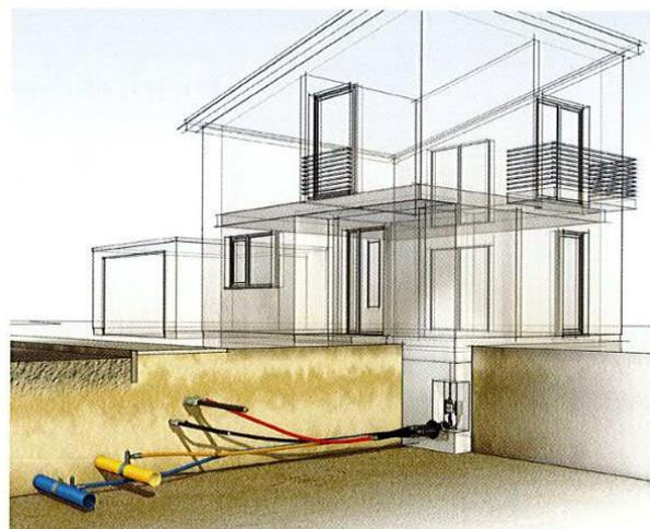
Industriell gefertigte, geprüfte und fachgerecht eingebaute Einführungssysteme (Einzelsparten- oder Mehrsparten-Hauseinführungen) gewährleisten dauerhaft eine gas- und wasserdichte Durchführung für alle Kabel und Rohre.
