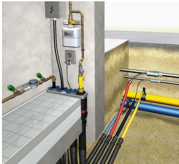
Mehrsparteneinführung für Wasser/Gas/Strom/Telekommunikation
