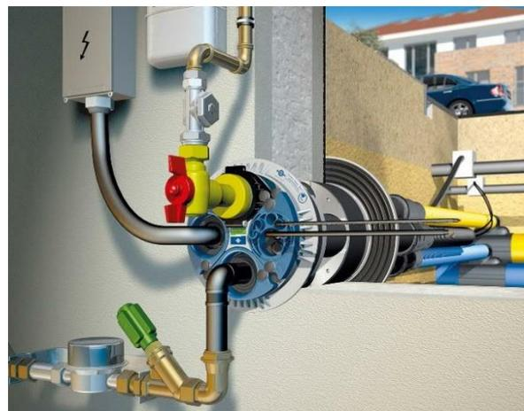
Mehrsparteneinführung für Wasser/Gas/Strom/Telekommunikation
